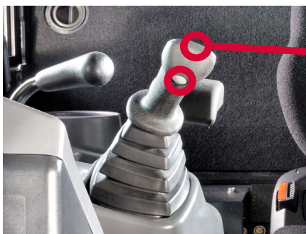
1 P.T.O hold button potentiometer
